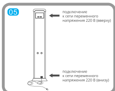
05 Произведите настройки. Проверьте работоспособность. Закрепите изделие к полу с помощью крепежных элементов. Изделие готово к работе.
