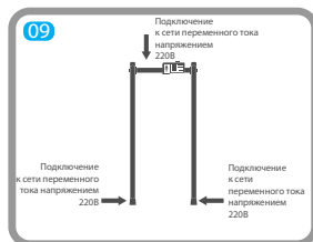
06 Подключите кабели от электронного блока к обеим панелям и подключите шнур электропитания к одной из панелей.
