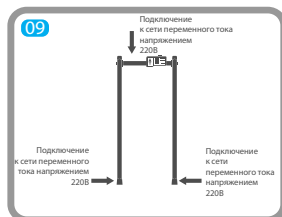
09 Подключите к сети переменного тока напряжением 220В. Подключение к сети переменного тока напряжением 220В. Подключение к сети переменного тока напряжением 220В.
