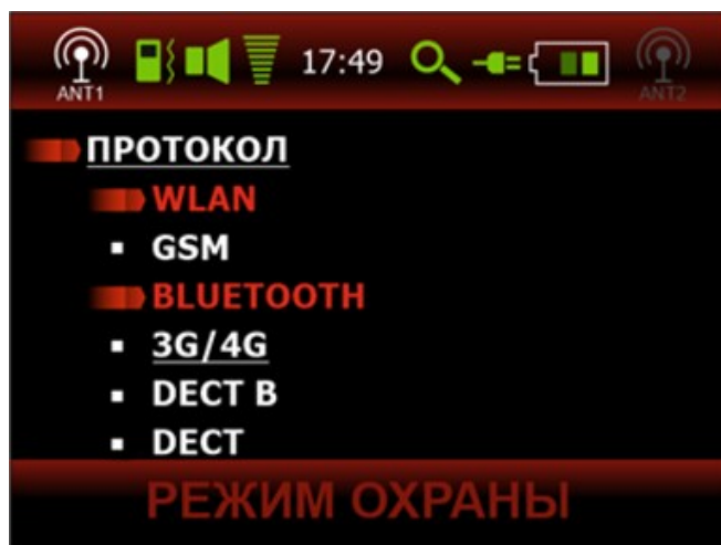
Рис. 20 – Включение отдельных выбранных протоколов в перечень тревожных событий
