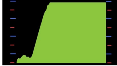
Рис. 9 - Увеличение уровня сигнала по мере приближения к аналоговому радиопередатчику
