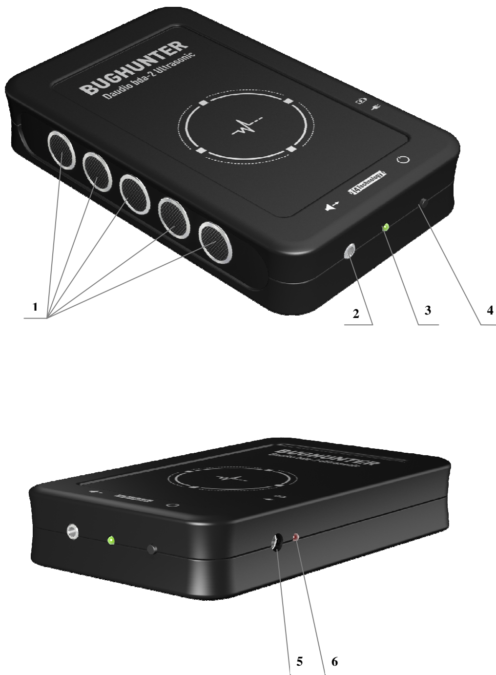
Рисунок 2 – Расположение основных частей изделия
