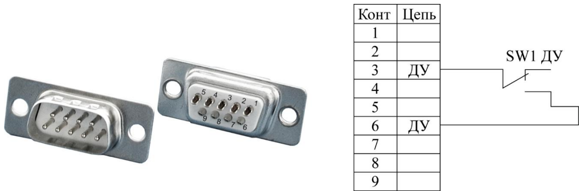
Рисунок 5 - Схема распайки разъемов вилки DB-9М
